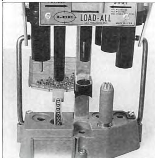
**ГНЕЗДО 4.** Поместите гильзу под соответствующий бур - надрезатель. Придерживайте внутри бура гофрированное дульце гильзы для правильного совмещения надрезов гильзы с ребрами бура. Нажмите ручку до упора. Для некоторых гильз может понадобиться две секунды для усадки пластика.
