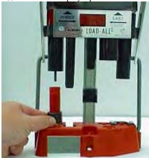
**ГНЕЗДО 1.** Наденьте на гильзу калибровочное кольцо так, чтобы конец с канавкой был вверху. Установите гильзу в ГНЕЗДО 1 и потяните за ручку вниз. Произойдет полная обжимка по длине и извлечение использованного капсюля из гильзы.
