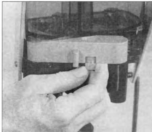
3. Извлеките два винта из фирменной планки. Снимите загрузочную рейку и установите требуемые мерки для дроби и пороха, согласно таблице по зарядке. При сборке, винты закручивайте аккуратно, не перетягивая их.
